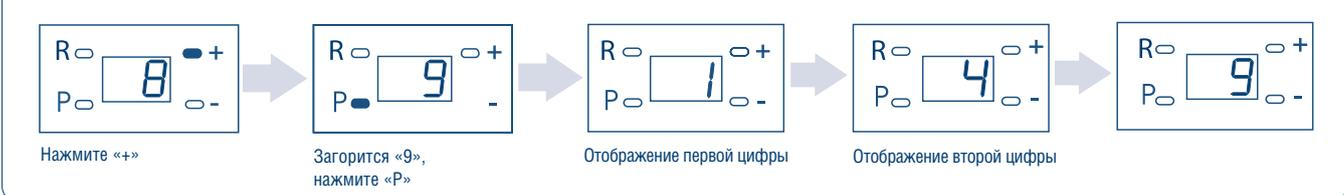
При входе в 9-й пункт меню последовательно отображаются две цифры. После отображения цифр программа возвращается в основное меню.
