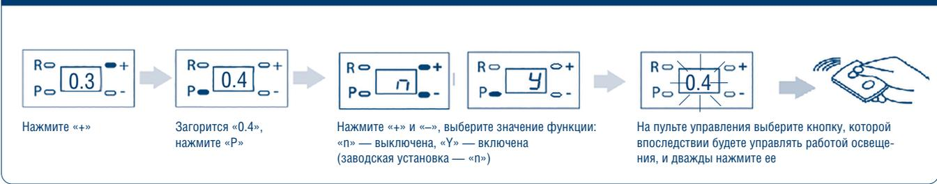
Рис. 6.4.5. Функция управления встроенным освещением привода
