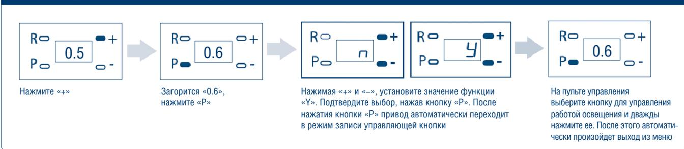
Рис. 6.4.7. Изменение скорости движения ворот (только для привода FAST-800PRO)
