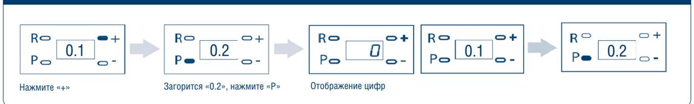
После того как вы зайдете в пункт меню «0.2», на дисплее отобразится поочередно четыре числа. Это значение показывает абсолютное количество циклов (открывания/закрывания) работы привода с момента производства.
