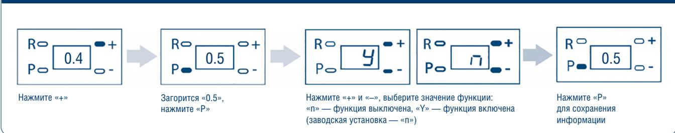
Запись кнопки пульта для управления встроенным освещением. Нажимая «+» и «-», установите значение функции «У». Подтвердите выбор, нажав кнопку «Р». После нажатия кнопки «Р» привод автоматически переходит в
