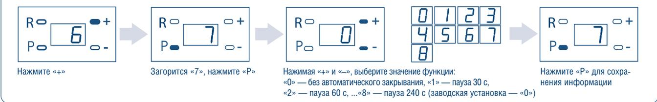
**Рис. 6.3.8. Сброс параметров до заводских настроек**
