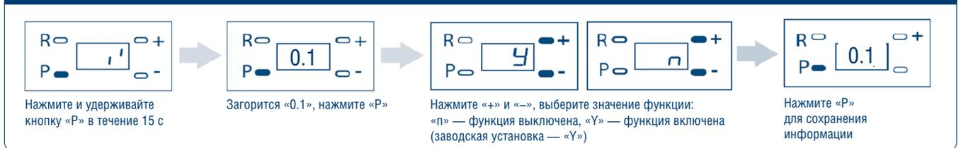
Рис. 6.4.2. Абсолютный счетчик циклов
