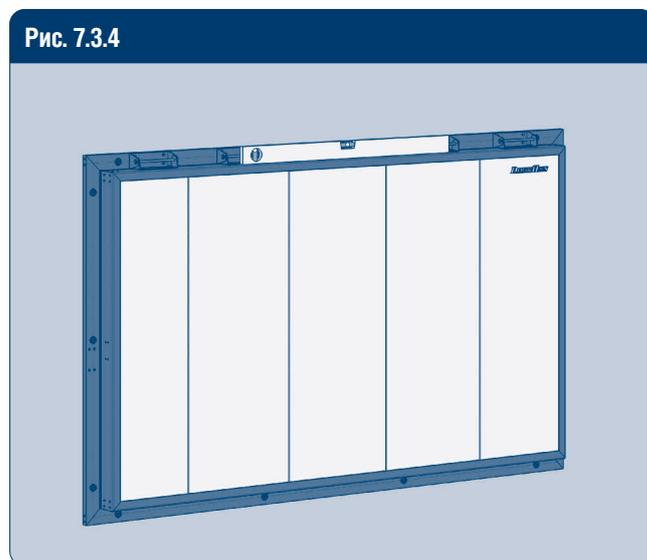
Через отверстия на полотне клапана установите петли с помощью винтов  $M5 \times 25$  мм. Широкая часть петли должна находиться снизу.
