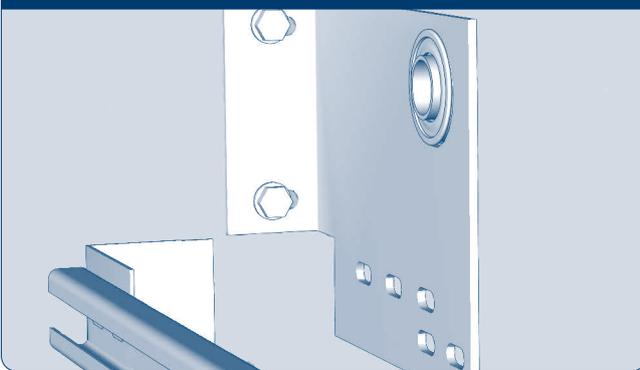
Просверлите намеченные отверстия в стене сверлом  $\varnothing 12$  мм, вставьте дюбели и закрепите кронштейн с помощью саморезов. Аналогично закрепите опорный кронштейн с другой стороны проема.
