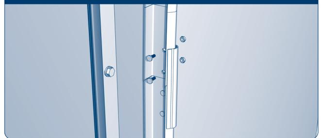
Скрепите горизонтальные и вертикальные направляющие между собой при помощи двух болтов для сборки направляющих с гайками и с соединительной пластиной, располагающейся в месте стыка направляющих.
