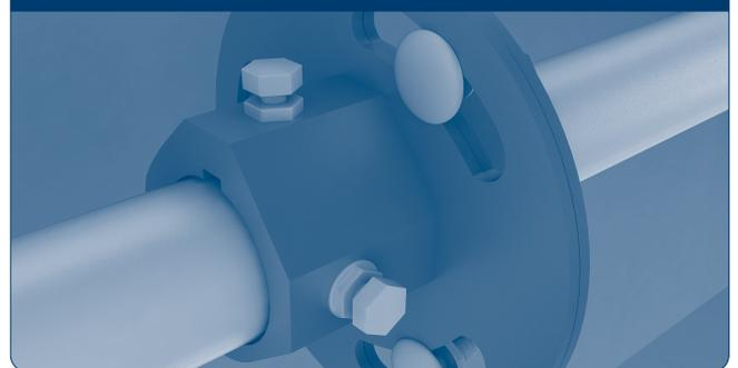
Ослабьте болты, соединяющие две части муфты. Отрегулируйте натяжение тросов путем вращения двух частей вала. Зафиксируйте новое положение муфты при помощи болтов с гайками.
