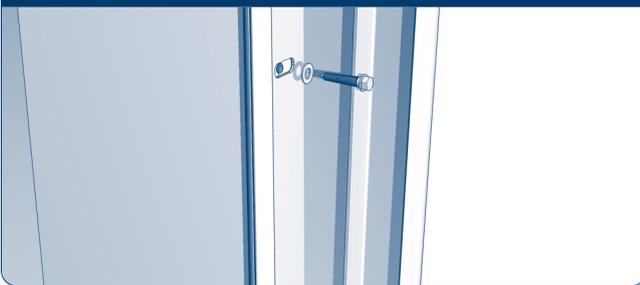
Закрепите угловые стойки к стене проема двумя саморезами с шайбами, но не затягивайте их. Выставьте вертикальные направляющие по уровню и только после этого затяните саморезы.
