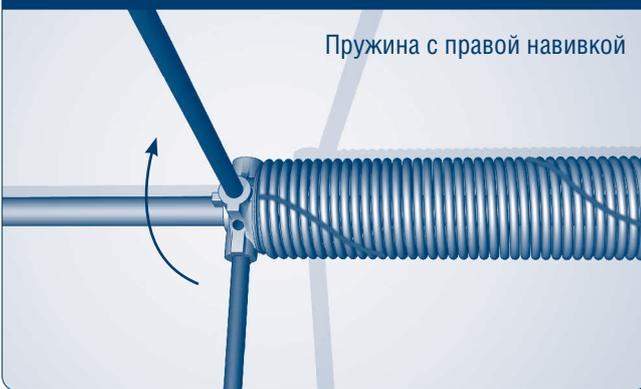
На пружине проведена краской специальная разметочная полоса, служащая для указания количества закрученных витков пружины. Расчетное число оборотов указано в монтажной карте и на наклейке на полотне ворот.
