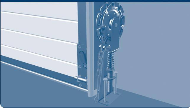
Вставьте анкерные болты в просверленные отверстия и затяните их.
