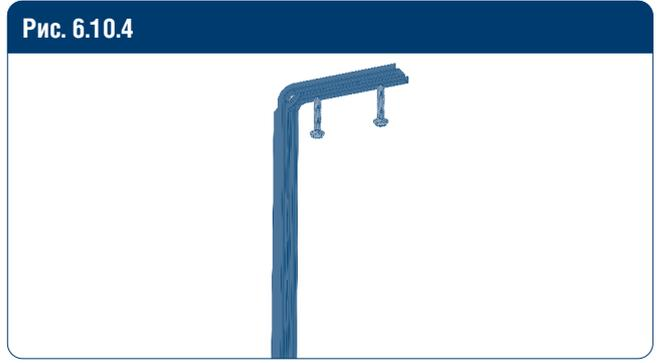
Просверлите отверстия сверлом  $\varnothing 10$  мм и вставьте дюбели. Закрепите кронштейн при помощи саморезов с шайбами.
