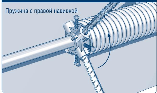
После взведения пружины зафиксируйте ее, положив упоры под монтажные воротки, затяните болты крепления окончания пружины к валу и вытащите воротки.
