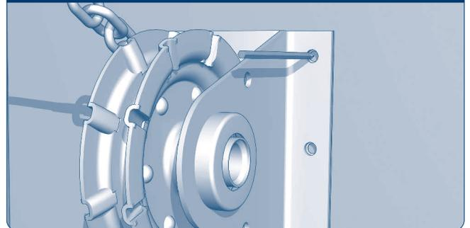
Установите натяжной ролик с фиксатором цепи на высоте 1 м и на одной оси с приводом. Разметьте и просверлите отверстия в стене для крепления натяжного ролика.
