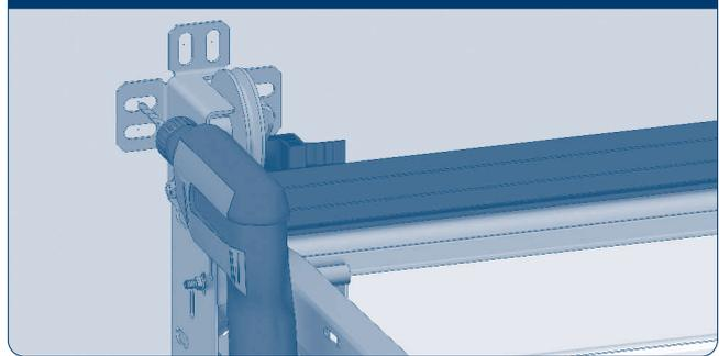
По отверстиям в угловой стойке установите шкив и зафиксируйте при помощи 4 болтов с полукруглой головкой M8 × 16. Разметьте и просверлите отверстия Ø8 мм в стене притолоки.
