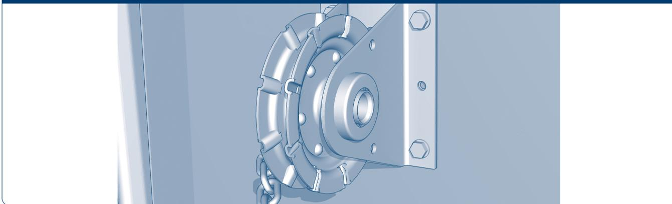
Вставьте дюбели в просверленные отверстия и закрепите натяжной ролик при помощи саморезов.
