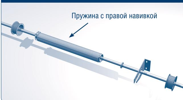
Торсионный механизм устанавливается в концевые опорные кронштейны и дополнительно поддерживается универсальным внутренним кронштейном.
