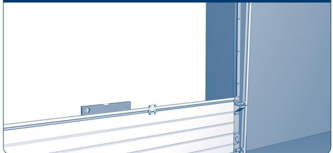
Выровняйте нижнюю панель по строительному уровню. При необходимости используйте подкладки соответствующей толщины.
