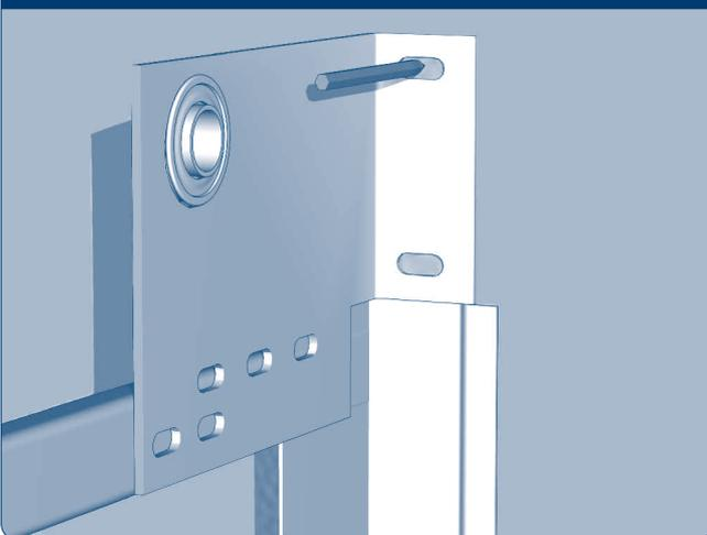
Установите опорный кронштейн вплотную к стене и угловой стойке, совместив при этом отверстия в кронштейне и стойке. Разметьте отверстия для крепления к С-профилю и стене проема по перфорации в опорном кронштейне.
