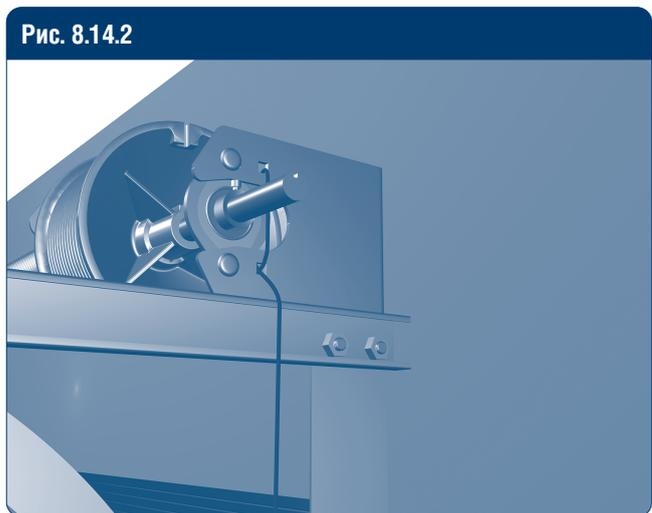
Второй конец фала закрепите в любом свободном отверстии угловой стойки или концевом опорном кронштейне.
