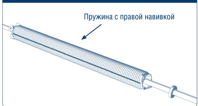
Установите на вал пружину в сборе. Для пружины с правой навивкой фланец для крепежа к универсальному внутреннему кронштейну находится справа. Со стороны кронштейна устанавливается подшипник узкой стороной внутрь фланца окончания пружины. Пружина с левой навивкой устанавливается зеркально.
