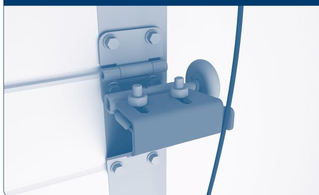
Опору троса закрепите к боковой опоре с помощью двух болтов с полукруглой головкой и двумя соответствующими гайками. Трос необходимо завести за специальное ухо на опоре троса.
