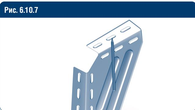
Разметьте отверстия для крепления кронштейна к потолку.
