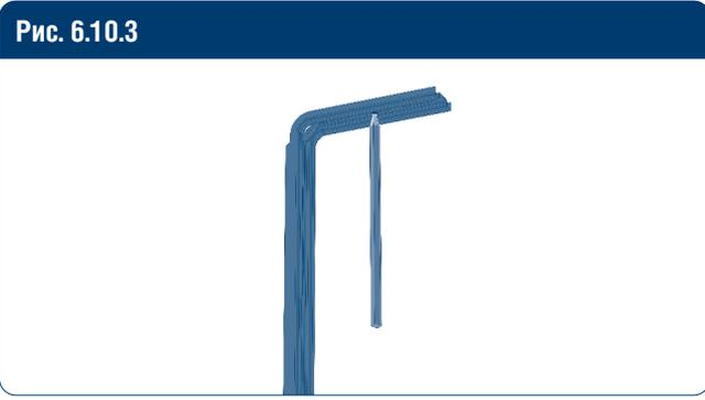
Разметьте отверстия для крепления кронштейна к потолку.
