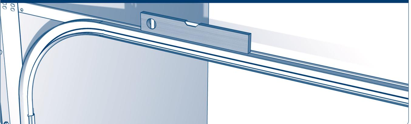
Закрепите С-профиль горизонтальной направляющей к угловой стойке. Перед затяжкой болтов необходимо выставить направляющие с помощью строительного уровня.
