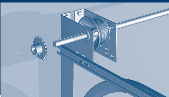
Установите на вал звездочку, предварительно вставив шпонку в шпоночный паз. Зафиксируйте звездочку на валу крепежными болтами  $M8 \times 25$  мм. Аналогично закрепите звездочку на валу с другой стороны проема.
