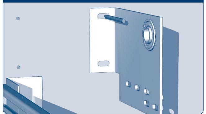
Симметрично с внутренней стороны установите второй опорный кронштейн, для чего приставьте его к стене проема и наметьте места его крепления к стене. Расстояние между кронштейнами должно быть таким, чтобы можно было разместить барабан.
