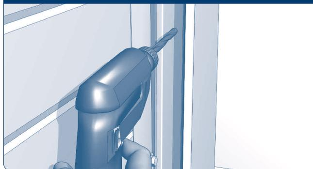
Просверлите отверстия  $\varnothing 4,2$  мм для крепления задвижки и отверстие  $\varnothing 15$  мм в угловой стойке для вхождения ригеля задвижки.
