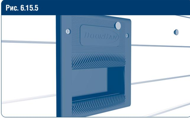
Затяните саморезы, на месте установки саморезов установите пластиковые заглушки.
