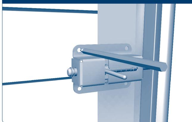
Разметьте и просверлите 4 отверстия сверлом  $\varnothing 4$  мм на глубину 15–20 мм с внутренней стороны ворот для крепления корпуса защелки.
