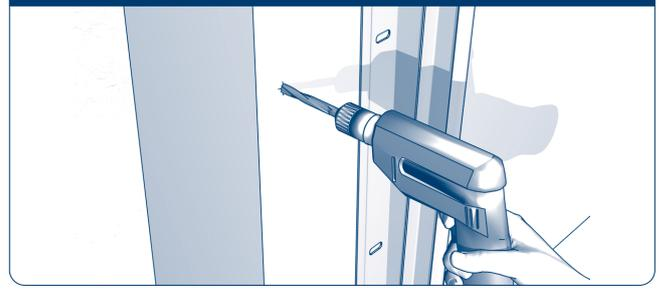
Просверлите отверстия  $\varnothing 10$  мм в стене проема. В отверстия забейте дюбели.
