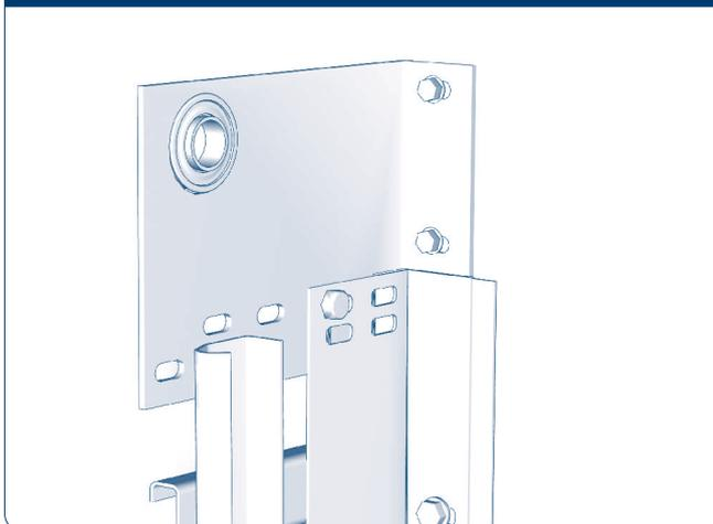
Закрепите к стене концевой опорный кронштейн при помощи дюбелей и саморезов.
