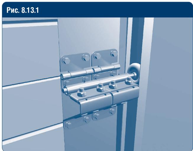
Двойные (усиленные) боковые опоры роликов используются в случае больших габаритов полотна ворот, когда нагрузка на один ролик превышает 35 кг.
