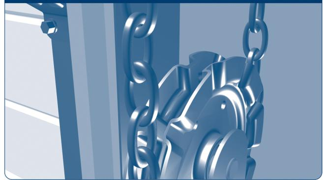
Проденьте цепь через привод и натяжной ролик.
