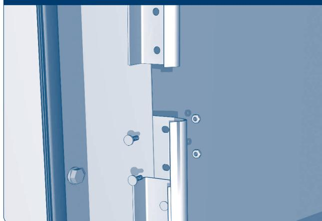
Скрепите горизонтальные и вертикальные направляющие между собой при помощи двух болтов для сборки направляющих с гайками и соединительной пластины, располагающейся в месте стыка направляющих.
