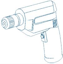
Рис. 3.2. Клепальный инструмент
