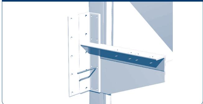
Прислоните выносной кронштейн для низкого вала к стене проема вплотную к угловой стойке (с внешней стороны) согласно монтажной карте. По перфорации в кронштейне сделайте разметку для его крепления к стене и угловой стойке.
