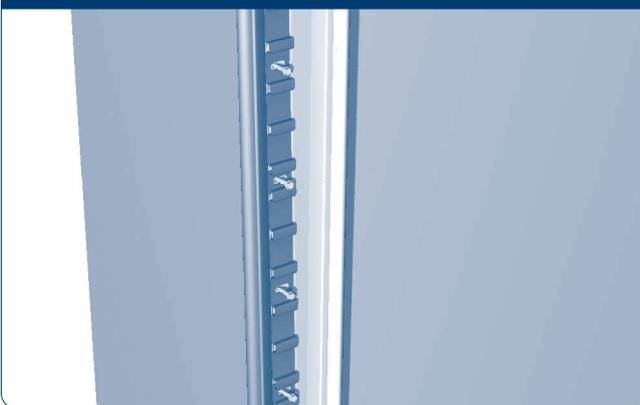
Установите накладки по отверстиям в угловой стойке и закрепите их одновременно со стойкой к стене проема с помощью саморезов с шайбами.
