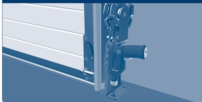
Установите натяжной ролик на полу, на одной оси с приводом. Разметьте и просверлите отверстия в полу для крепления натяжного ролика.
