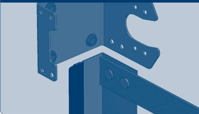
По перфорации в кронштейне разметьте отверстия для крепления в стене проема. Просверлите намеченные отверстия сверлом  $\varnothing 12$  мм. Забейте в стену дюбели. Закрепите кронштейн к притолоке при помощи саморезов (саморезы не затягивать).
