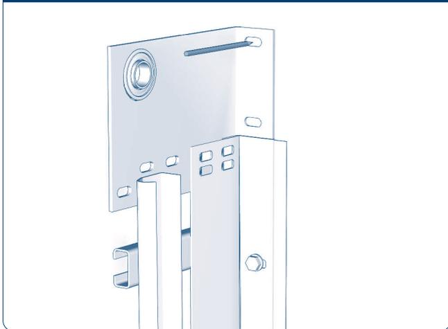
Установите концевой опорный кронштейн по отверстиям на угловой стойке и по перфорации в нем разметьте отверстия для крепления в стене проема.
