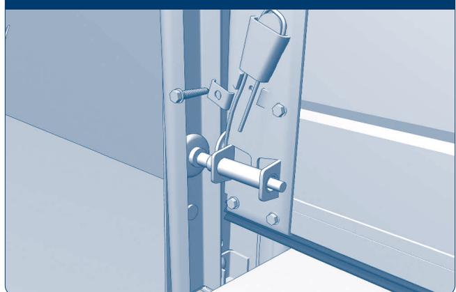
Выверните саморез, крепящий свободный конец троса, с помощью скобы крепления троса к основанию кронштейна, расположенного на приподнятом углу полотна ворот. Снимите скобу.
