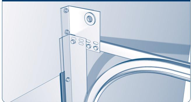
Установите концевой опорный кронштейн по отверстиям на угловой стойке. По перфорации в кронштейне разметьте отверстия для крепления в стене проема. Просверлите намеченные отверстия в С-профиле сверлом  $\varnothing 8,5$  мм и в стене сверлом  $\varnothing 12$  мм. Забейте в стену дюбели. К стене закрепите концевой опорный кронштейн при помощи саморезов. Скрепите концевой опорный кронштейн, С-профиль и угловую стойку между собой при помощи болтов  $M8 \times 25$  с гайками.
