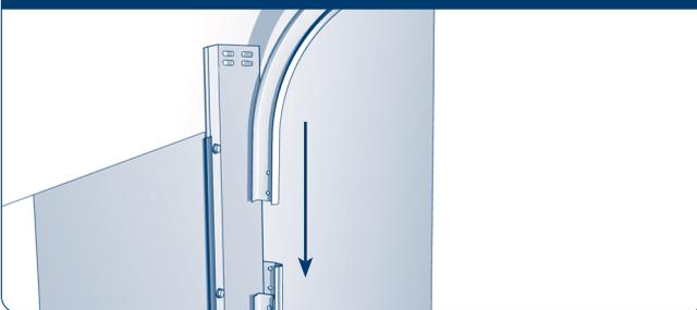
Горизонтальные направляющие поставляются в сборе с С-профилем, служащим для повышения жесткости направляющих. В С-профиле и в горизонтальных направляющих сделаны отверстия для крепления с вертикальными направляющими и угловой стойкой.
