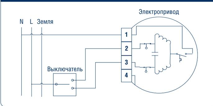
Рис. 6. Недопустимое параллельное подключение
