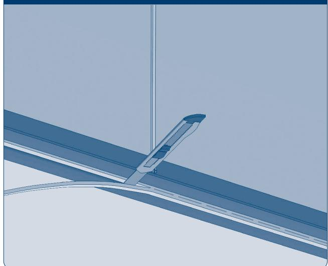
Обрежьте лишнюю часть полотна под утяжелителем.
