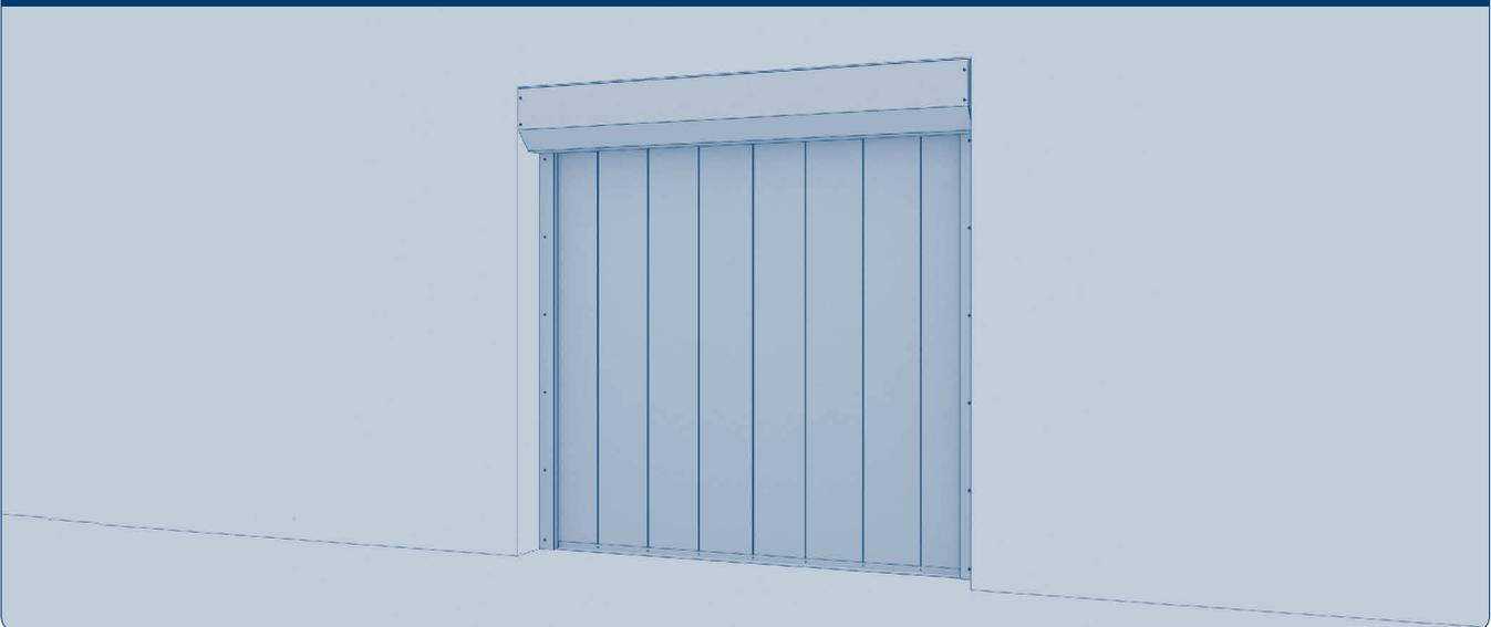
Проверьте правильность и надежность установки конструкции. Поднимите и опустите несколько раз полотно противопожарной шторы. Убедитесь в отсутствии посторонних звуков и в надежности крепления всех элементов.
