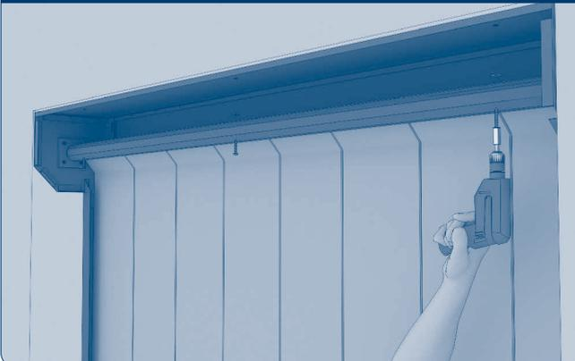
Для крепления к притолоке из металла с помощью шуруповерта закрепите верхнюю часть короба кровельными саморезами по металлу с шайбами по ранее подготовленным отверстиям.
