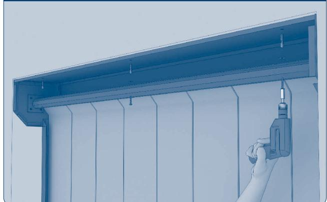
Установите дюбели в отверстия в притолоке для крепления в кирпич или бетон. С помощью шуруповерта закрепите верхнюю часть короба к притолоке саморезами с прессшайбами без сверла и шайбами увеличенными.
