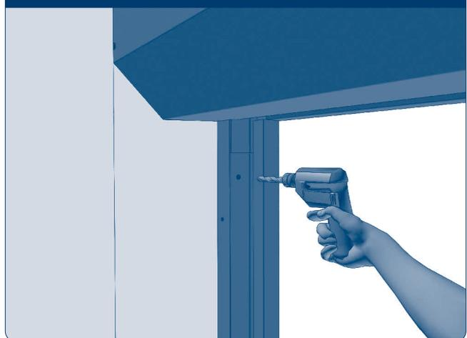
Просверлите отверстия для крепления каркаса противопожарной шторы к стене.
