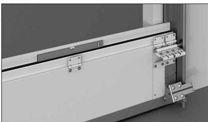
Затем по панели установите вертикальные направляющие. Расстояние от торцевой поверхности панели до кромок направляющих должно составлять около 40-45 мм.
