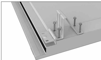
Установите боковые опоры по просверленным отверстиям, используя 4 самореза 6,3x38 мм.
