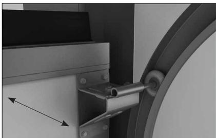
Установите верхнюю панель. Отрегулируйте положение верхнего ролика, обеспечив плотное прилегание панели к проему.
