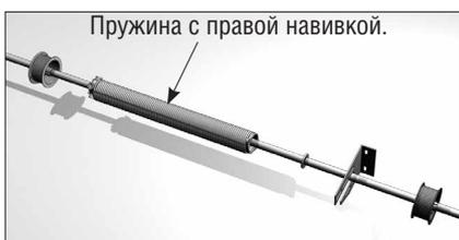
Торсионный механизм устанавливается в концевые опорные кронштейны и дополнительно поддерживается универсальным внутренним кронштейном.
