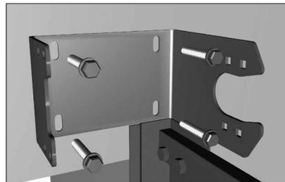
Установите п-образный кронштейн вплотную к угловой стойке, совместив углы крон- штейна и угловой стойки. Внешняя стенка кронштейна должна совпадать с плоско- стью угловой стойки. По перфорации в кронштейне разметьте отверстия для крепле- ния в стене проема. Просверлите намеченные отверстия сверлом  $\varnothing 12$  мм. Забейте в стену дюбели. Закрепите кронштейн к притолоке при помощи саморезов (саморезы не затягивать).
