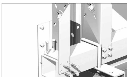
Установите внутренние выносные кронштейны для крепления барабанов на трубе согласно размерам, указанным в монтажной карте, и закрепите их с помощью саморезов по металлу.
