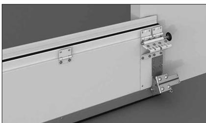
Перед установкой направляющих необходимо установить в проем нижнюю панель таким образом, чтобы ее края заходили за проем равномерно с двух сторон на 100 мм.
