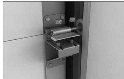
Установите ролики с роликодержателями на боковые опоры с помощью болтов M8x25
