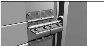
Двойные (усиленные) боковые опоры роликов используются в случае больших габаритов полотна ворот, когда нагрузка на один ролик превышает 35 кг.
