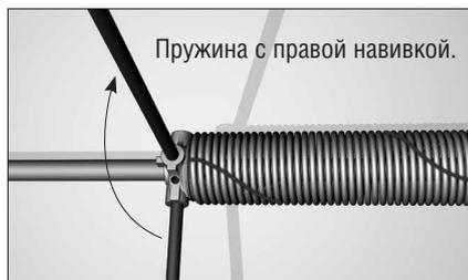
На пружине проведена краской специальная разметочная полоса, служащая для указания количества закрученных витков пружины. Расчетное число оборотов указано в монтажной карте.
