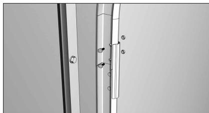
Скрепите горизонтальные и вертикальные направляющие между собой при помощи двух болтов 1/4"x3/4" для сборки направ- ляющих с гайками и соединительной пла- стины, располагающейся в месте стыка направляющих.
