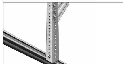
Закрепите кронштейн к горизонтальной направляющей при помощи закладной пластины (стр. рис.) и болта с гайкой.
