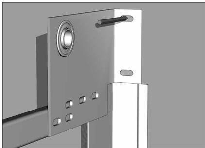
Установите опорный кронштейн вплотную к стене и угловой стойке, совместив при этом отверстия в кронштейне и стойке. Разметьте отверстия для крепления к с-профилю и стене проема по перфорации в опорном кронштейне.
