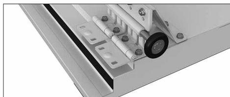
Разберите боковые опоры с держателями роликов. Установите опоры по просверленным отверстиям и закрепите при помощи саморезов 6,3х38 для панелей.
