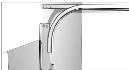
Горизонтальные направляющие постав- ляются в сборе с с-профилем, служащим для повышения жесткости направляющих. В с-профиле и в горизонтальных направ- ляющих сделаны отверстия для крепления с вертикальными направляющими и угло- вой стойкой.
