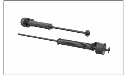
Направление закрутки пружин должно совпадать с направлением ее навивки. Т.е. для правой пружины направление закрутки должно осуществляться против часовой стрелки, а для левой – по часовой стрелке.
