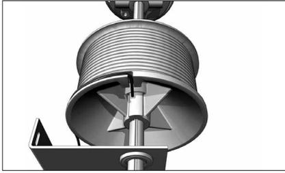
Разрежьте трос на две равные части. Пропустите свободный, не обжатый втулкой, конец троса через просверленное отверстие в барабане, протяните его вдоль направляющих и выведите к устройству защиты от обрыва троса. Установите барабан к опорному кронштейну, намотайте на него трос на то количество витков, которое указано в монтажной карте. Закрепите барабан на вале крепежными болтами.
