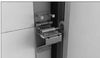
Закрепите верхние части петель боковых опор с помощью саморезов 6,3x38 для панелей.
