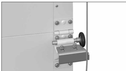
При установке секционных ворот с высоким/вертикальным типом подъема, с расположением барабана снизу, на боковые опоры нижней панели необходимо устанавливать опоры троса для исключения перетирания троса о боковую опору.
