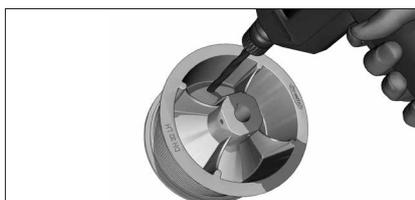
В случае отсутствия обжимного винта на барабане в боковой поверхности барабанов просверлите отверстие сверлом под диаметр троса для пропускания свободного конца троса.
