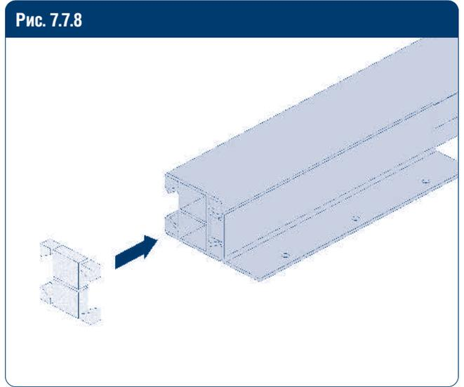
Перед заливкой необходимо заглушить торцевые отверстия профиля пенопластовым бруском для того, чтобы раствор не попал в полость профиля.
