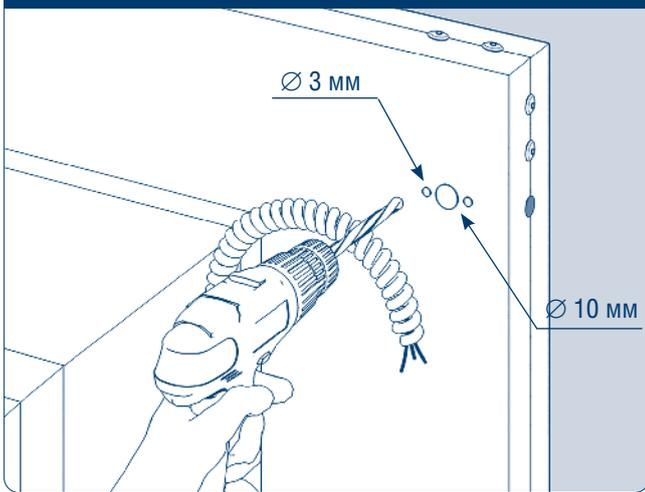
Просверлите отверстие в раме  $\varnothing 10$  мм для вывода обогревающего кабеля и два отверстия  $\varnothing 3$  мм для установки монтажной коробки.
