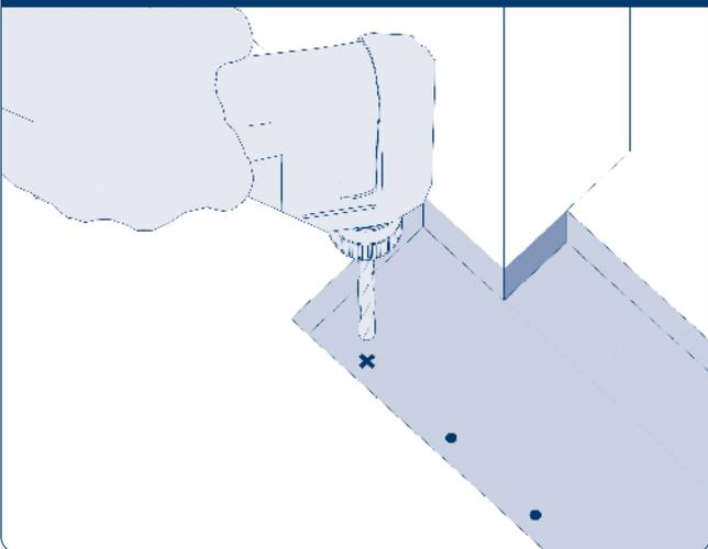
Просверлите отверстия  $\varnothing 8$  мм по ранее отмеченным местам крепления.
