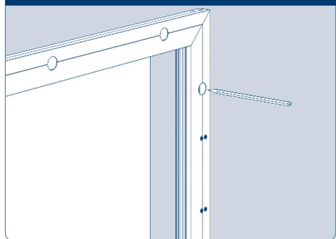
По имеющимся на раме отверстиям, используя карандаш, выполните разметку для крепления рамы к проему.
