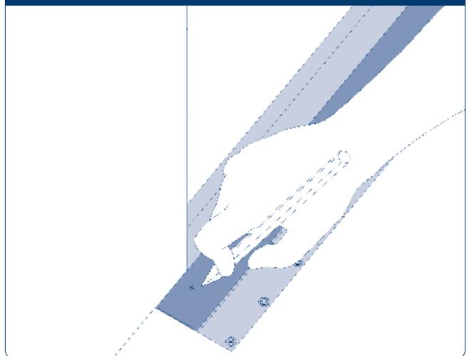
Отметьте следующее место вывода обогревающего кабеля.
