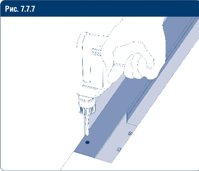
Просверлите отверстие для вывода обогревающего кабеля.
