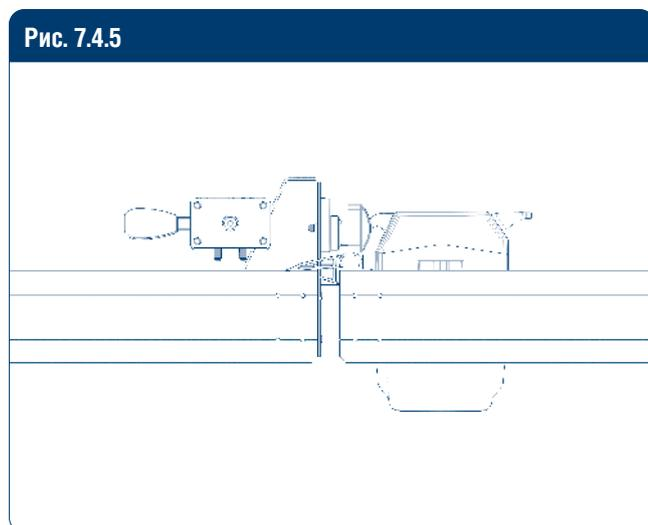
С помощью регулируемой ответной части замка обеспечьте надежное запираение замка, прижатие уплотнителя к раме и срабатывание запорного элемента без дополнительного усилия.
