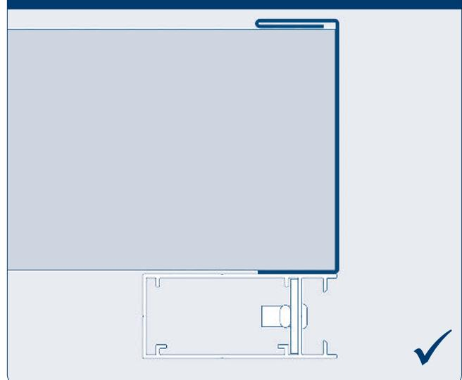
В случае установки двери в прорезанный проем стены из сэндвич-панелей, используйте окантовку без завальцовки со стороны прилегания рамы.
