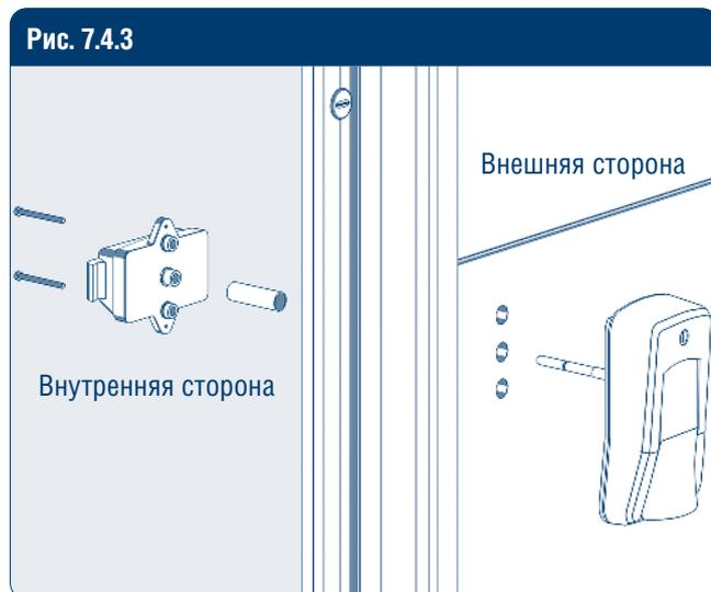
В заранее подготовленные отверстия на полотне двери установите ручку с замком, втулку, шток замка.
