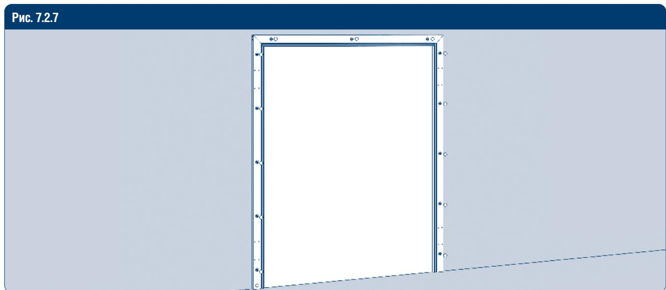
Монтажные отверстия в раме закройте декоративными заглушками и установите декоративные крышки на их место. В случае монтажа обогревающего кабеля см. раздел 7.5.
