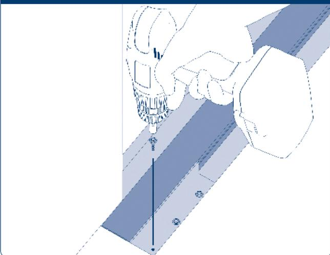
Зафиксируйте порог саморезами-глухарями  $8 \times 70$  мм.
