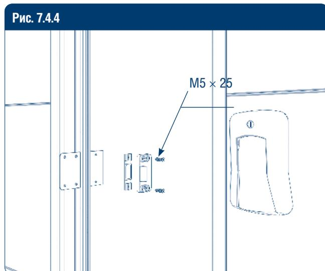
Через отверстия в раме полотна пассивной створки установите регулируемую ответную часть замка с помощью винтов M5 × 25 мм.
