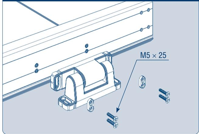
Через отверстия на полотне двери установите петли с помощью винтов  $M5 \times 25$  мм. Широкая часть петли должна находиться снизу.
