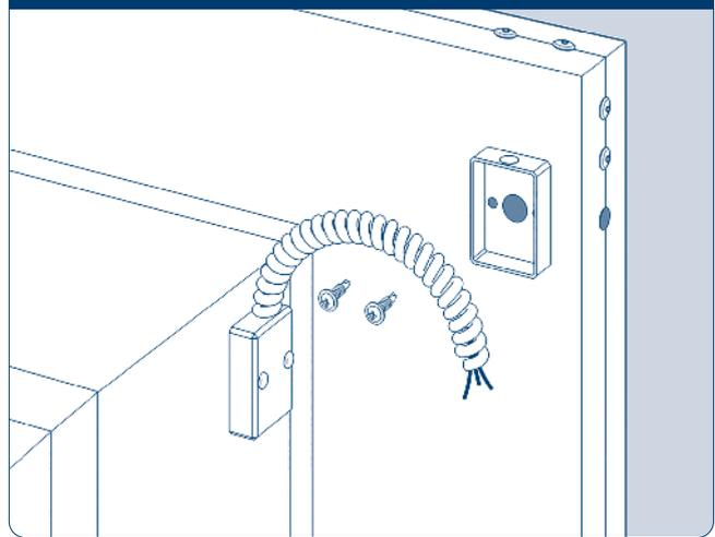
Установите монтажную коробку с помощью саморезов  $\varnothing 3,5$  мм.
