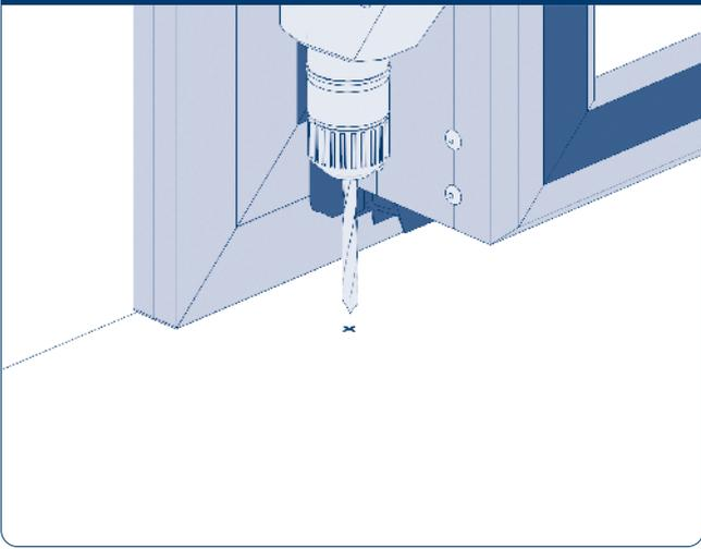
Просверлите отверстия  $\varnothing 8$  мм по ранее отмеченным точкам.
