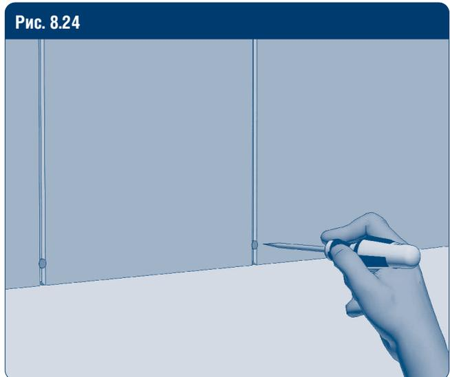
Проделайте отверстия в полотне шторы для установки утяжелителя.
