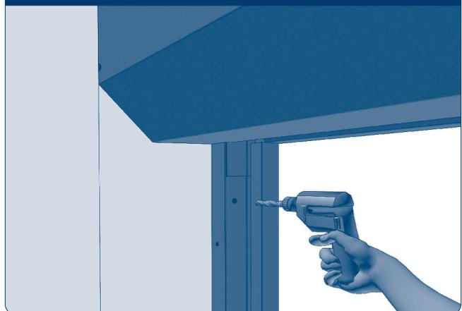
Просверлите отверстия для крепления каркаса противовыдymной шторы к стене.
