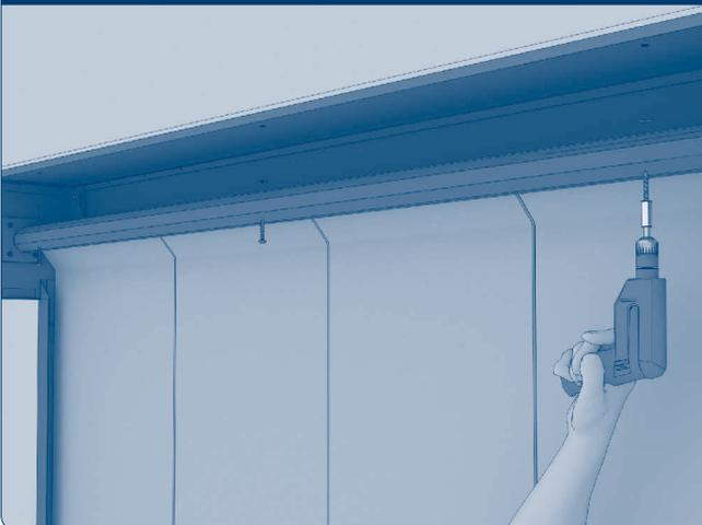
Для крепления к притолоке из металла с помощью шуруповерта закрепите кровельными саморезами по металлу с шайбами верхнюю часть короба по ранее подготовленным отверстиям.
