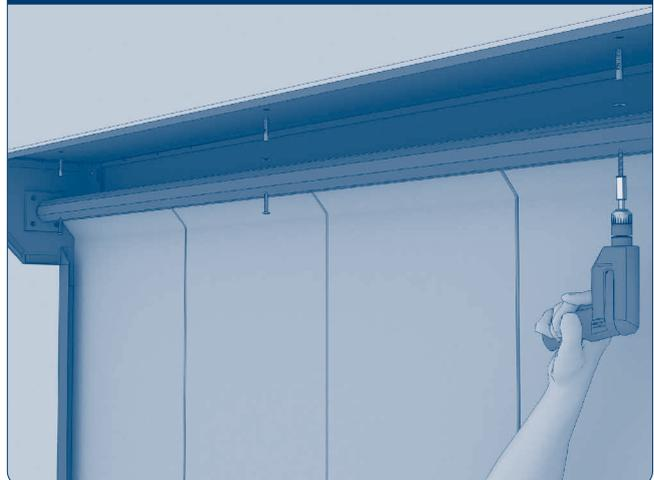
Установите дюбели в отверстия в притолоке для крепления в кирпич или бетон. С помощью шуруповерта закрепите верхнюю часть короба к притолоке саморезами с прессшайбами без сверла и шайбами увеличенными.
