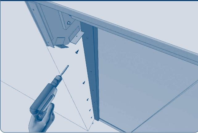
Закрепите крышки направляющих при помощи винтов.
