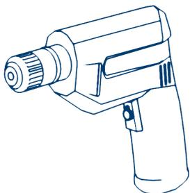
Рис. 6.5. Шурупверт аккумуляторный
