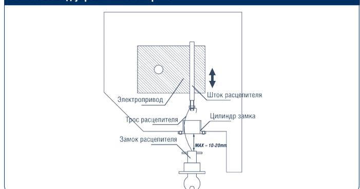
Рис. 7. Вывод управления через стену
