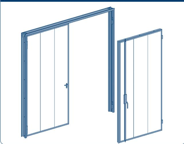
Навесьте створку в сборе с ригельной задвижкой на ось с полупетлей вертикальной стойки. Зазор между створкой и полом должен составлять 20–25 мм. Расположение ригельной задвижки может быть также с наружной стороны открывания ворот.
