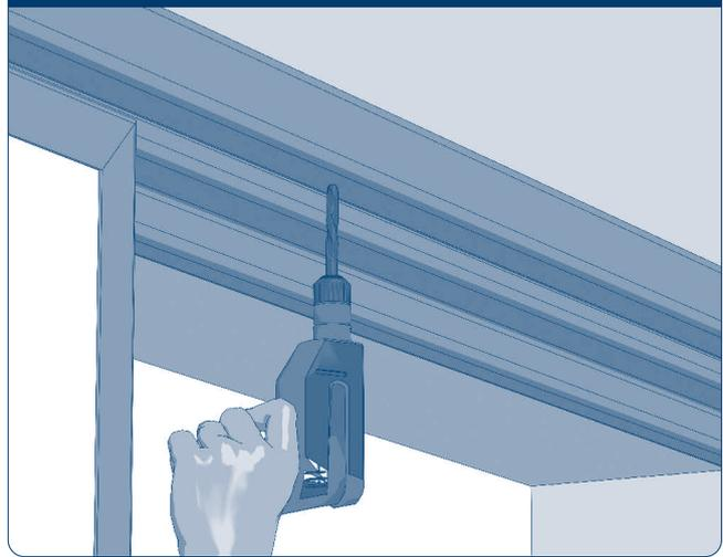
При монтаже ригельной задвижки с внутренней стороны открывания ворот отметьте место для ее фиксации в горизонтальном профиле и просверлите отверстие диаметром 15 мм.
