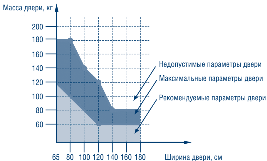
Рис. 1.2. Предельно допустимые размеры двери, автоматизируемой приводом AD-SWING
